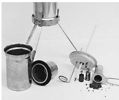
▲ FIGURA 9.4 Dispositivo de calorimetría El vaso para calorimetría (centro, con anillo negro aislante) entra en el recipiente grande. La tapa con el termómetro y el agitador aparecen a la derecha. Se calientan municiones o trozos de metal en el vaso pequeño (con mango), el cual se inserta en el agujero en la parte superior del generador de vapor que está en el trípode.
