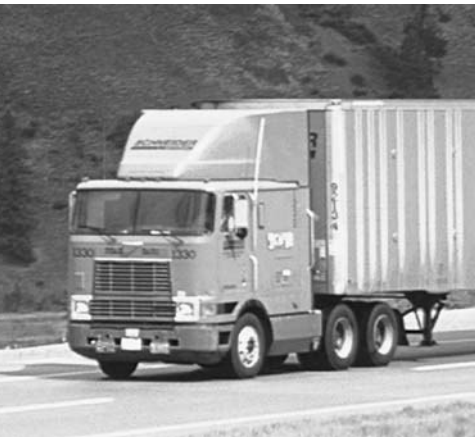
▲ FIGURA 2.23 Superficie aerodinámica La superficie sobre el techo de la cabina de este camión hace aerodinámico al vehículo y así reduce la resistencia del aire, volviéndolo más eficiente.
