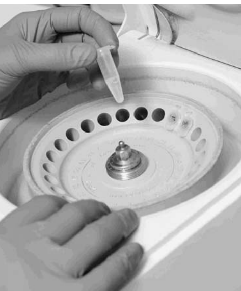
▲ FIGURA 5.10 Centrífuga Se usan centrífugas para separar partículas de diferente tamaño y densidad suspendidas en líquidos. Por ejemplo, en un tubo de centrífuga es posible separar los glóbulos rojos de los blancos y del plasma que constituye la porción líquida de la sangre.
